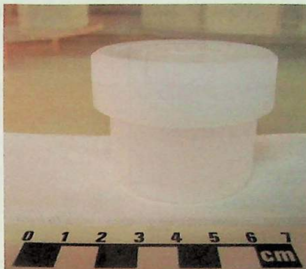
Figura 9. Frasco de teflon de 100mL utilizado para armazenar a amostra de água durante as fases iniciais de seu tratamento para análises isotópicas de estrôncio.
